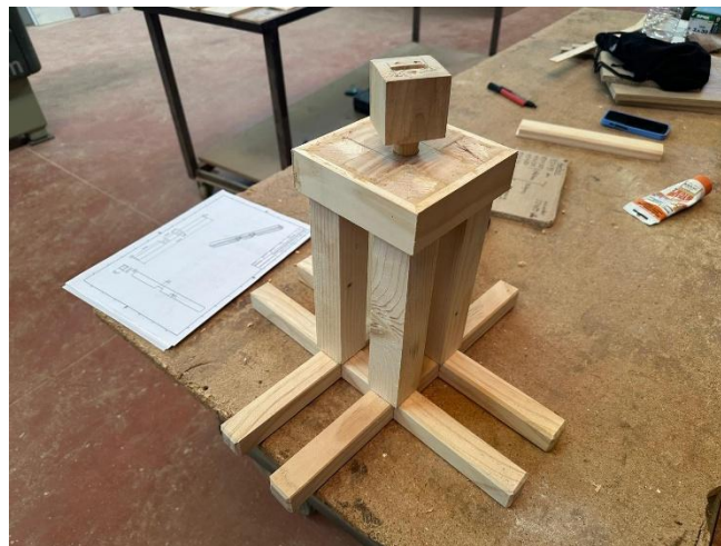
Ilustración 58. Ensamblaje de base cruciforme. Fuente: Elaboración propia
