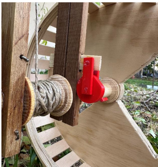
Ilustración 62. Freno accionado. Fuente: Elaboración propia
