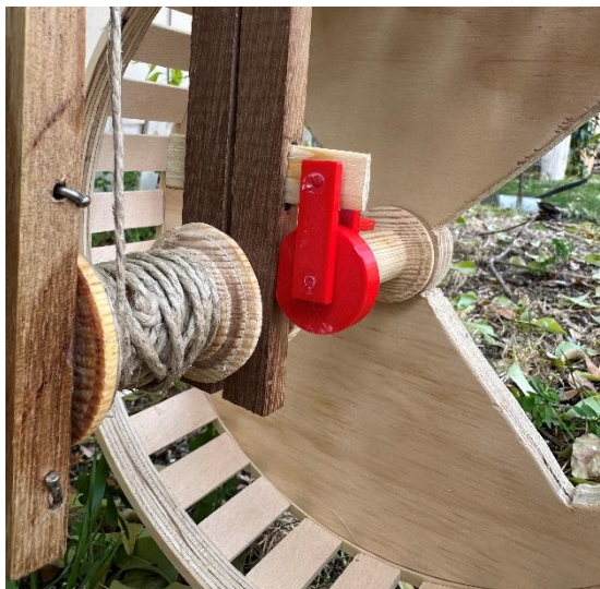
Ilustración 61. Freno sin accionar (eje con libre giro). Fuente: Elaboración propia
