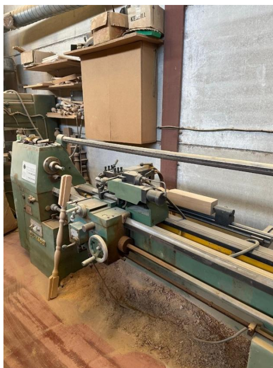
Ilustración 47. Torno empleado para crear eje. Fuente: Elaboración propia
