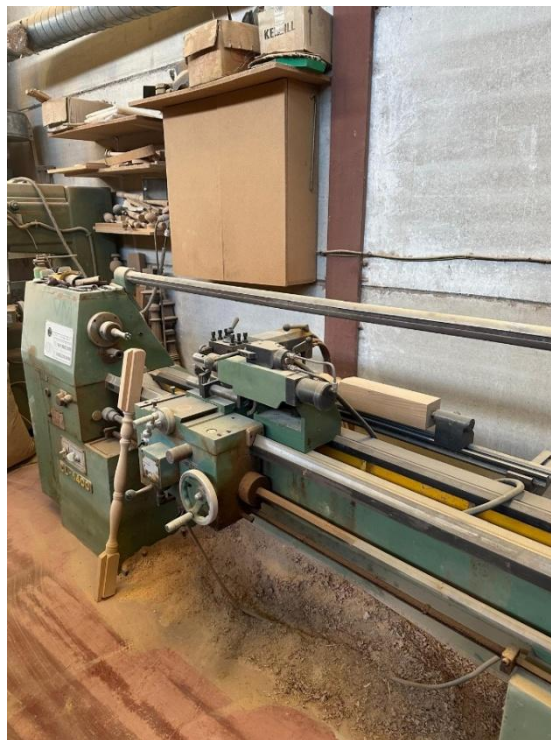
Ilustración 46. Torno empleado para crear eje. Fuente: Elaboración propia
