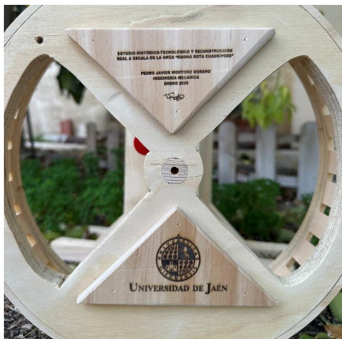
Ilustración 62. Grabado en madera mediante láser. Fuente: Elaboración propia
