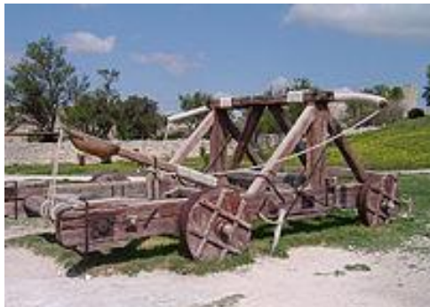
Ilustración 16. Catapulta de tensión. Fuente: Wikipedia.com
